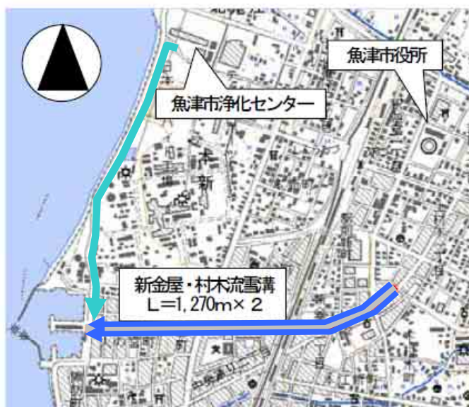
図3.23 下水温度差エネルギー利用システムの導入事例（魚津市）
