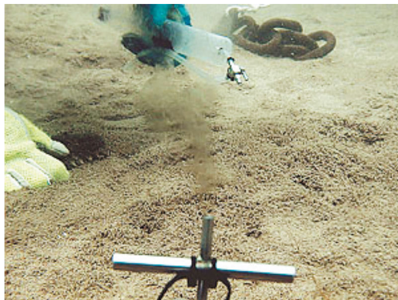
魚津市青島沖の海底湧水:海底に刺した管から噴出する海底湧水 塩分濃度の違いから揺らいで見える。(富山大学・張勁教授)
