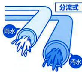
魚津市の下水道は、汚水と雨水を別々の系統で排除する分流式といわれる方式を採用しています。
