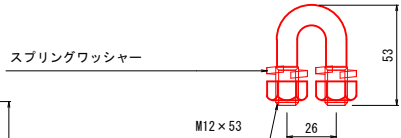
Uボルト (φ12用) 詳細図 S=1:2
