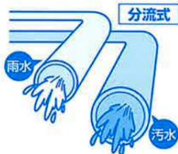
魚津市の下水道は、汚水と雨水を別々の系統で排除する分流式といわれる方式を採用しています。
