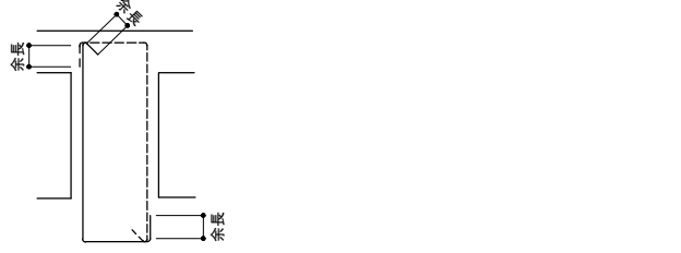
図2-3-6 副あばら筋・副帯筋の形状
