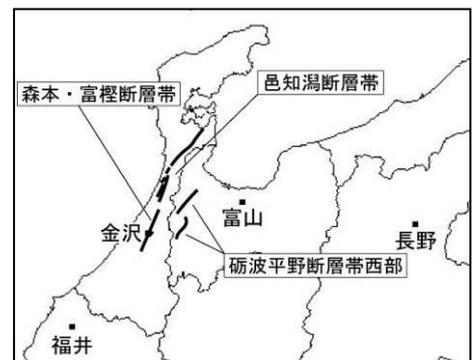
帯である。全体の長さは約44 kmで、ほぼ北東－南西方向に延びる。本断層帯は、断層の南東側が北西側に対して相対的に隆起する逆断層である。
