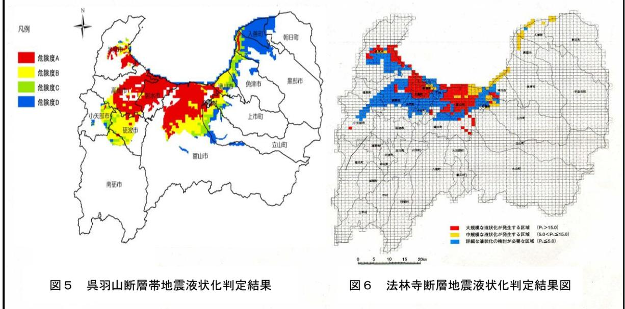
図5 呉羽山断層帯地震液状化判定結果
