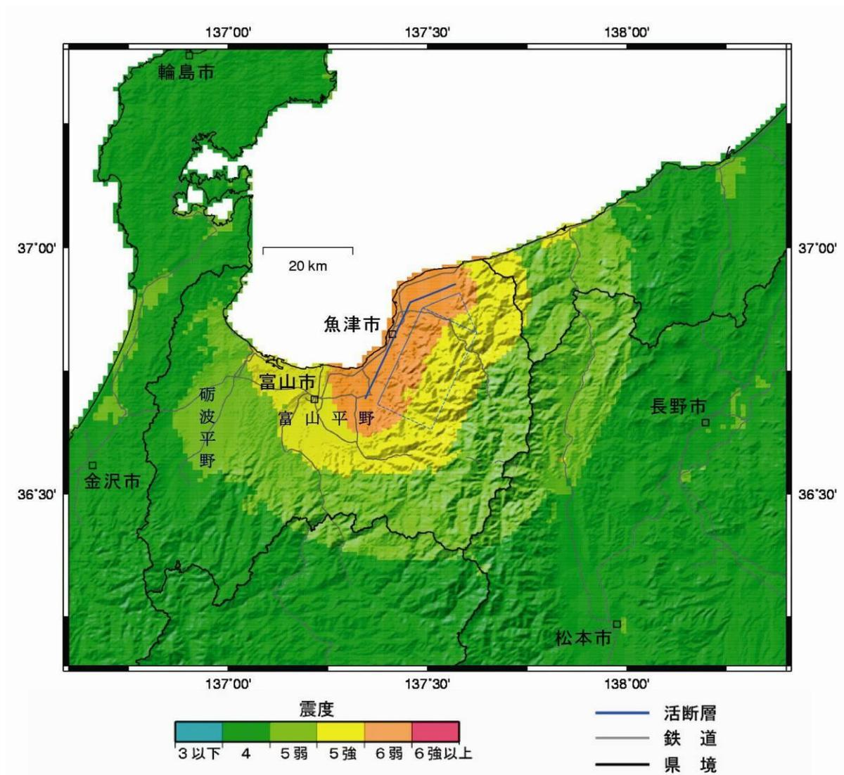
長さ32kmの魚津断層帯が一度に活動した場合、その地震の規模（マグニチュード）は、7.3程度になると推定されている。上の図はこのような地震が発生した場合に予測される震度分布を示している。
