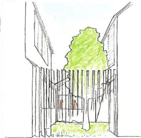
昔ながらの町家に思われる中庭は 通風、換気のためになくてはならない空間である 取り巻く全ての諸室に潤いを与える樹木は 固定してそのまま残す 隣地とのブロック塀は 空気の流れを遮らないルーバーとして 居住性を向上させる
