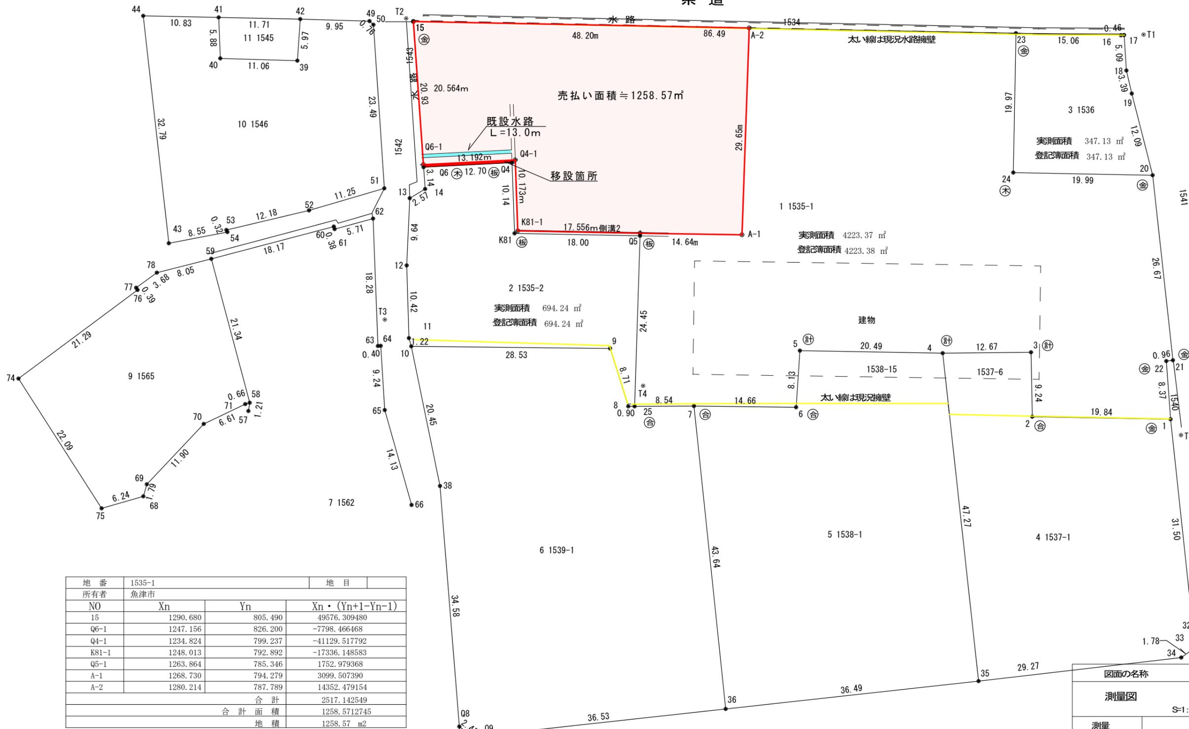
\*注記 3, 4, 5の筆界点は、建物内部の為 計算点として確認を受け求積している
