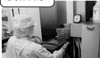
トレイを立てて流すことのできる、コンベア式の大きな洗浄機で、食器やトレイを洗浄した後、温風で消毒乾燥を行います。
